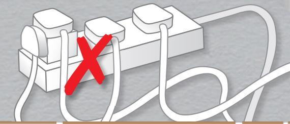
Tidak boleh ada lebih dari satu adaptor atau satu kabel ekstensi yang masuk ke dalam stopkontak.
